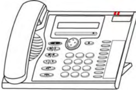
Base di supporto, utilizzabile anche come telaio di montaggio per l'installazione a parete
